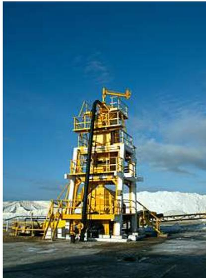
Fig.6 – Torre de lavagem de sal ([http://www.norsal.com.br/img/img\\_produzido/torre\\_lavagem1.jpg](http://www.norsal.com.br/img/img_produzido/torre_lavagem1.jpg))
