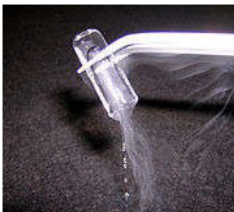
FIGURA 2. As três fases do néon estão bem visíveis no pequeno pedaço de gelo de néon em fusão rápida.
