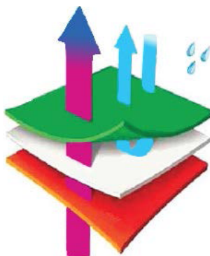
FIGURA 3. Esquema de funcionamento da membrana Gore-Tex®.
